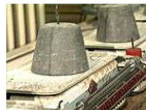
Mit alten Küchenwaagen werden Kräfte gemessen.
