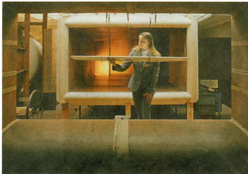
Der Windkanal des Hubschraubervaters Henrich Focke arbeitet wieder: Ein Blick durch die Düse in die offene Meßstrecke. Foto Ingo Wagner
