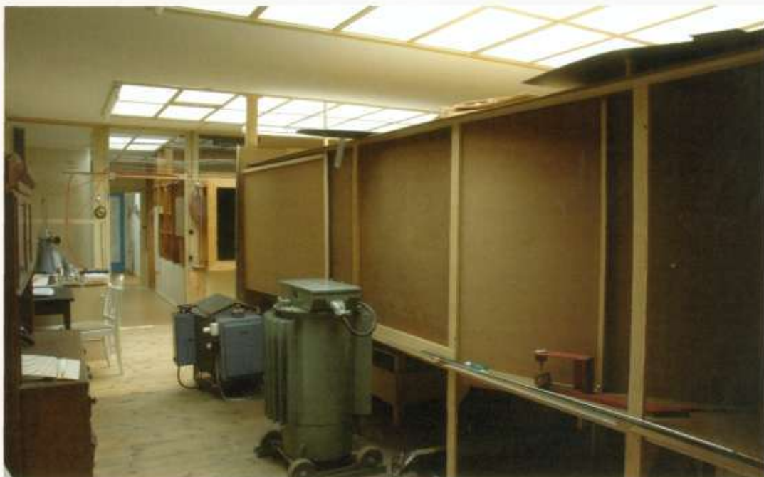
Blick in die Windkanalhalle. Im Hintergrund links der Messtisch, gegenüber die Messstreckenöffnung. Die beiden Geräte im Vordergrund dienen zur Erzeugung eines gleichmäßigen Rotorlaufs und zur Regulierung der Windgeschwindigkeit.
