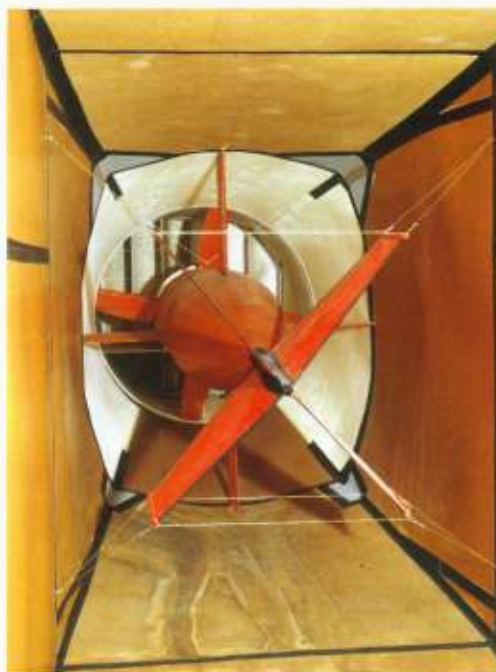
Der Rotor zur Winderzeugung. Das Innere des Windkanalgehäuses lässt Billigbauweise und Spuren von Wasserschäden erkennen.
