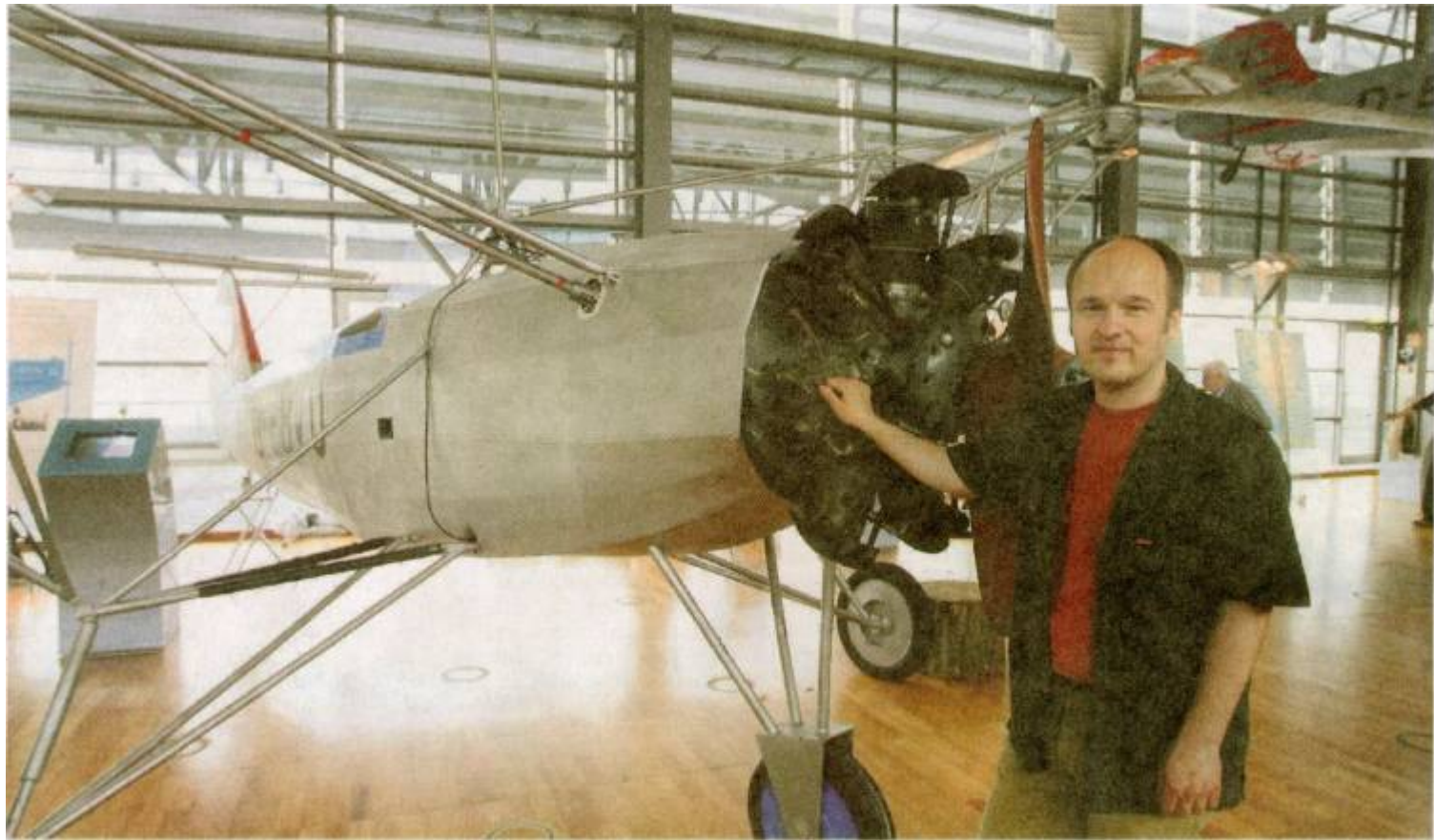
Kai Steffen vom Focke-Windkanal e.V. vor dem Nachbau des Hubschraubers FW-61 in Originalgröße. Grundlage war der Rumpf der „Stieglitz“, angetrieben wurde der Helikopter von zwei Rotoren. Einer davon ist über dem Kopf von Kai Steffen zu sehen.
